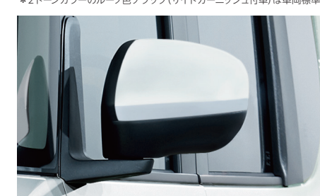
ドアミラーカバー(ホワイト) ¥10,340 [¥5,000 +税¥4,400] 08400F2215A7 *カバーのみの交換となります。交換時に取外した車両部品は再使用不可。 *ドアミラーガーニッシュとの同時装着の場合は、ドアミラーカバーを先に装着してください。 *ボディカラー WH (A7) と同一色。 *2トーンカラーのルーフ色ホワイト(サイドガーニッシュ付車)は車両標準。
