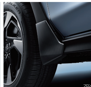
■スプラッシュボード ¥24,090 [¥19,500+税¥2,400] J1017FN200 ●樹脂製、無塗装ブラック。 ※装着部地上高がフロント最大30mm、リヤ最大50mm下がります。
