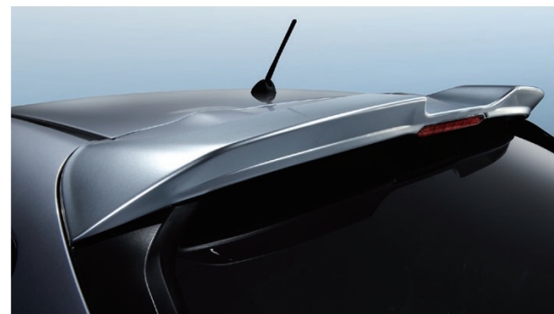
□ルーフスポイラー ¥54,340 [¥43,000+税¥6,400] E7217FN020## <STIルーフスポイラーと共着不可> ●ボディ同色。●標準装備のルーフスポイラーに貼付け(ボルト&ナット締め)。
