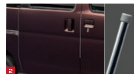
2 メッキ調のきらめくモールが、ドアのエッジを守ります。
