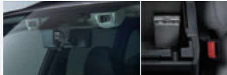
*本体はフロアコンソールボックス内、カメラはルームミラー前方のフロントガラスに装着。
