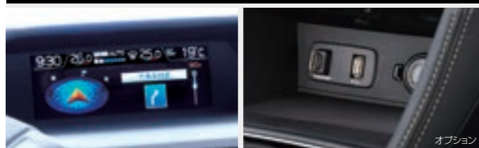
マルチファンクションディスプレイ表示例 ※実際の速度規制に従って走行してください。 外部入力ユニット インパネ(HDMI/USB) センタートレイに装着(車両のUSB電源と交換取付)。
