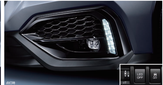
■LEDアクセサリライナー ¥61,600 [¥50,000+税¥6,000] H4517VC220 ●ON/OFFスイッチ付。車両標準装備のフロントの車幅灯部分がアクセサリランプとして常時点灯します。車幅灯部分は停車時のみヘッドランプのライティングスイッチで消灯できます。クリスタルブラック・シリカ塗装。 ※他の灯火類とは色味が異なります。◆注意事項は下記参照。 ◆LEDアクセサリライナーの注意事項: ※LEDアクセサリライナー本体は専用のスイッチで点灯/消灯します。 車幅灯部分の点灯/消灯とは連動しません。双方のスイッチがONの場合、同時点灯します。
