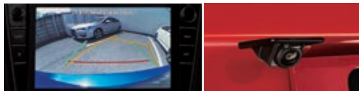
● 距離目安 ● 車幅延長 ● 予想進路 約31万画素C-MOSカメラ 画角:水平約142°/垂直約111° (写真はリヤビューカメラブローワー付)
