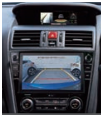
写真はリヤビューカメラ&ディスプレイコーナースセンサー共着・後退時、フロントセンサー接近距離も数値表示せず(車両のフロント/サイドビューモニター&後退時プレーキアシストはマルチファンクションディスプレイ表示)。
