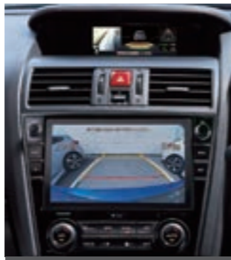
写真はリヤビューカメラ&ディスプレイコーナーセンサー共着・後退時、フロントセンサー接近距離も数値表示します(車両のフロント/サイドビューモニター&後退時プレーキアシストはマルチファンクションディスプレイ表示)。
