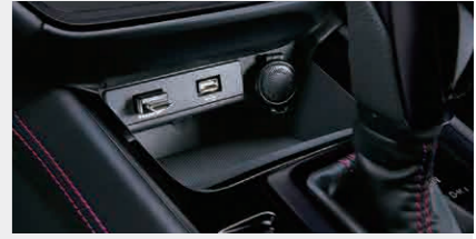
外部入力ユニット インパネ(HDMI/USB) センタートレイに装着(車両のUSB電源と交換取り付け)。
