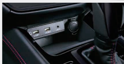
外部入力ユニット インパネ(USB×2/AUX) センタートレイに装着(車両のUSB電源と交換取付け)。
