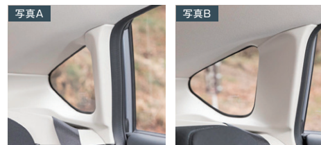
インプレッサのCピラー。写真Aはドライバーの視点から見た形状。写真Bは同じピラーを後席のヘッドレストあたりから見たもの。(写真は5代目インプレッサです)
