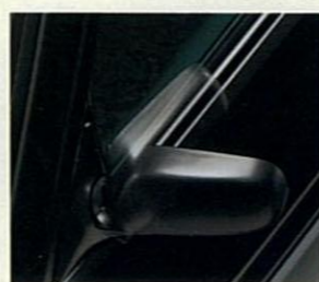
電動格納式ドアミラー(T/tb, S/tb)。 T/tbはカラード&ヒートアップドアミラー。
