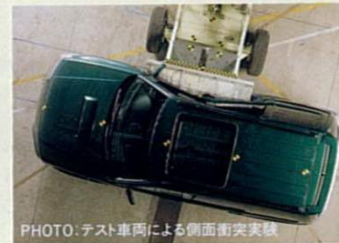
PHOTO:テスト車両による側面衝突実験
