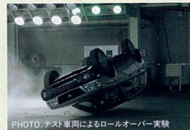
PHOTO:テスト車両によるロールオーバー実験
