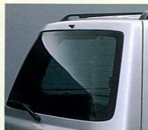
リヤゲート濃色ガラス(T/tb, S/tb, C/20)。 後方視認性確保のためスポーティバックの濃色 ガラスとは濃度が異なります。
