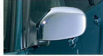
大型ドアミラー(メッキ) 電動格納式・ヒートッド機能付。
