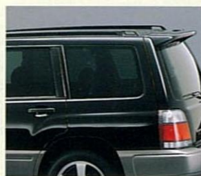
スポーティバック (T/tb, S/tb, C/20にメーカー装着オプション)。 リヤスポイラーとリヤドア&リヤクォーター濃色ガラ スのセット、濃色ガラスは、リヤドアとリヤクォーター ウィンドで濃度が異なります。
