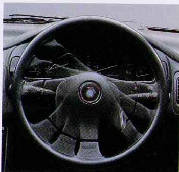
■パワーステアリング ナチュラルな操作感。そしてドライバーに走行フィーリングを的確に伝えるエンジン回転数感応型のパワーステアリングです。
