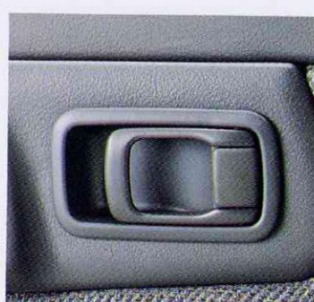
■集中ドアロック/リヤゲートロック 運転席ドアロックの操作により、全てのドアロックの開閉が行えます。
