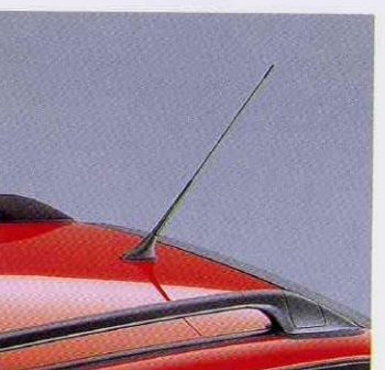
■ルーフアンテナ (HX Edition-S, HXエアサス, HX, CX) 高速走行時に風切り音が小さなスポーツワゴン専用ヨーロッパタイプのルーフアンテナ。
