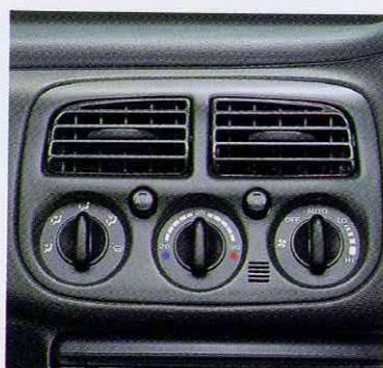
■オートエアコン (HX Edition-S, HXエアサス, HX, CXに標準装備。HS, CSにメーカー装着オプション) 温度を設定しておく、自動的に風量調節も行うオートエアコンです。
