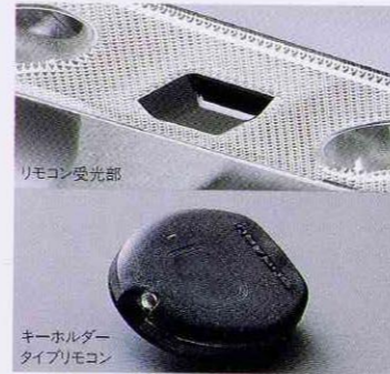
■赤外線リモコンドアロック (HX Edition-S, HXエアサス, HX) キーを差し込まずにドアロックの開閉が行えます。左右、後方から操作できます。
