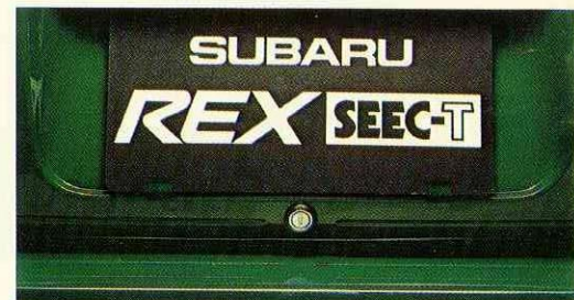
●エンジンフード・キーロック…ケーブル式からキーロック式に変更しました。
