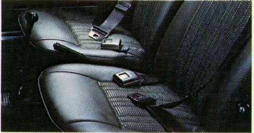
●安全ベルト...前席は連続ウエビングタイプ3点式を、後席は2点式安全ベルトを装備しました。
