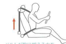
ベルトが胸に加える力を 抑えるロードリミッター
