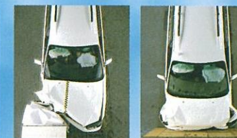
テスト車両によるフルラップ前面衝突試験
