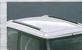
ダイレクトタイプブルーフレール。ボディ一体型にすることで車高を抑え、多くの立体駐車場に対応します。
