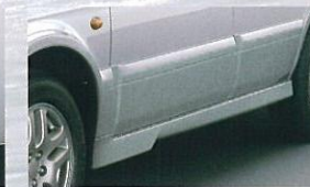
サイドクラディング。ボディ下部全周を飛び石などから保護する樹脂製カバー。
