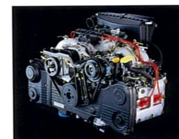
斜流タービン:排気の流れをスムーズにすることで過給効率を高めタービンの小型化を実現。アクセルレスポンスがさらに向上している。
