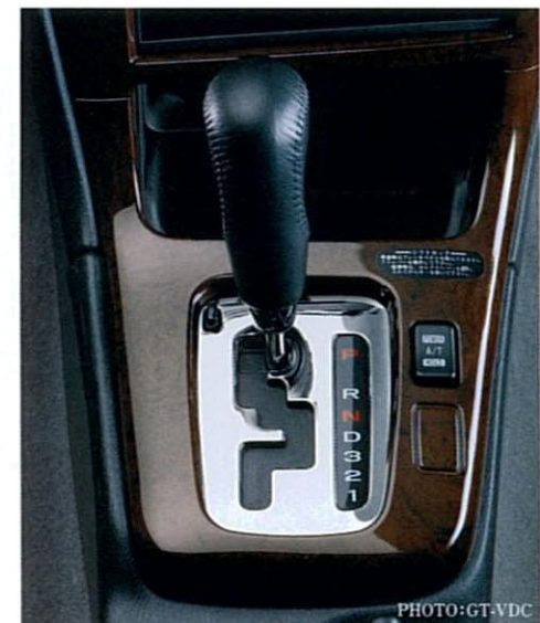
E-4ATゲート式セレクトレバー:P・R・N・D・3・2・1のポジションはスバルならではの、ボタン操作が不要で素早く確実なポジション移動が可能。
