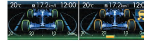
通常走行状態(写真はAWD車) VDC作動状態(写真はAWD車)
