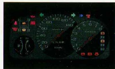
タコメーター 大型で視認性がよいタコメーター付コンビメーター。目が疲れにくい透過照明を採用。(ディアスIIサンサンルーフ、マレッサ) ※写真は撮影のため、すべての警告灯を点灯した状態です。
