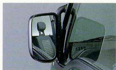
大型ドアミラー 見やすい大型のドアミラー。クラシックはクロームメッキタイプです。(ディアスIIサンサンルーフ、マレッサ)
