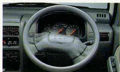
パワーステアリング 車速感応型の電動パワーステアリングです。※クラシック、ディアスSにはパワーステアリング非装着車を用意しています。
