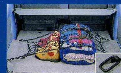
リヤラゲッジフック ラゲッジネット(ディーラーオプションF555TA001)を使って荷物を確実に固定することができます。(ディアスIIサンサンルーフ、マレッサ)
