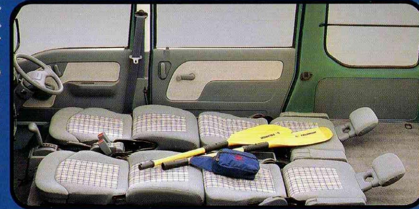
フルリクライニング フロントシートのピローを外して、シートをすべて倒せば、大人2人がゆったり身体を伸ばして横になれるスリーピングスペース。ドライブの途中で昼寝だって楽しめます。
