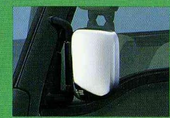
クロームメッキ大型ドアミラー サイドスタイルのワンポイント。大型のドアミラーにも、クロームメッキを施しています。
