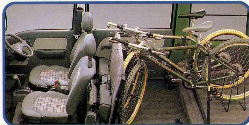
2人乗り+低床カーゴ 背の高い荷物を積むときは、ディアスならではの低床カーゴ。リヤシートをたたんで前に倒しフロアデッキを上げれば、フロントタイヤを外さずに自転車等が2台収納できます。
