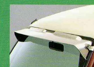
フロントバイザー(ブリックレッド色車) 前方からの直射日光をさえぎるフロントバイザー。ディーラー装着オプションでも設定しました。
