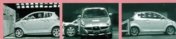
PHOTO:テスト車両による衝突試験(左:フルラップ前面、中央:側面、右:後面)
