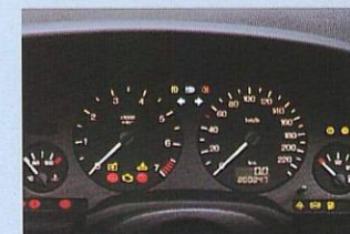
視認性の高いメーターデザイン 鮮明なコントラストにより視認性を高めるなどメーターデザインにもドイツの安全思想を徹底。スピードメーターは低速領域の目盛り間隔を大きくし、低速での速度確認がしやすい設計となっています。
