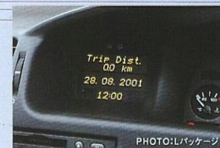
PHOTO:Lパッケージ インフォメーションディスプレイ オーディオ情報、日付、時刻、路面状況を知る目安となる外気温度を表示。Lパッケージにはさらに平均燃費、平均速度、走行距離、車両コンディションなどを表示するマルチシステムを採用しています。
