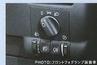
PHOTO:フロントフォグランプ装着車 ライト集中コントロール ヘッドライトの点・消灯や光軸調整、イルミネーションコントロール、フォグランプやフロントルームランプの点・消灯などが集中して行えます。 ※ヘッドライト点・消灯用のダイヤルを手前に引くと点灯
