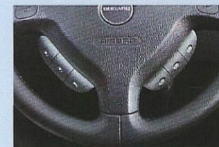
オーディオリモートコントロール付ステアリングホイール (Lパッケージに標準装備) ハンドルから手を離さずに、オーディオの各種操作ができます。
